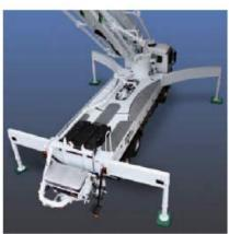
Die Kombination von Langhub-Batterie und Rock-Schieber fördert selbst schwierige Betone problemlos – und das bei minimalem Verschleiß und größter Laufruhe.
