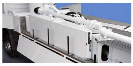
Der Anti-Torsionsrahmen, bei dem die Stützkräfte direkt an die Eckpunkte des Rahmens geleitet werden, bietet Platz für einen 600 I Öltank und Stauraum für Schläuche und Rohre.
