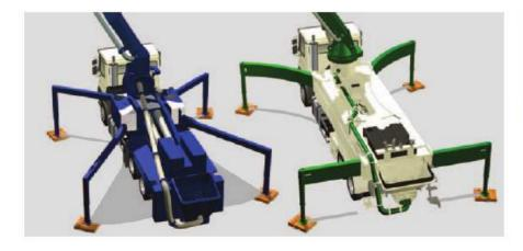
Die Kombination aus SX-Bogenabstützung vorne und hinterer H-Abstützung ermöglicht kurze Rüstzeiten und einen platzsparenden Aufbau. Gegenüber Maschinen mit raumgreifender hinterer Klappabstützung kommt die S 39 SX mit einer ca. 80 % geringeren Aufstellfläche aus.
