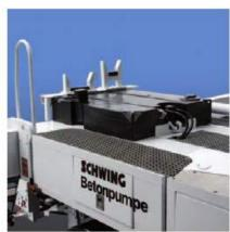
Der aufgeräumte Heckbereich, mit seinem 600 I Wassertank, bietet eine gute Zugänglichkeit.
