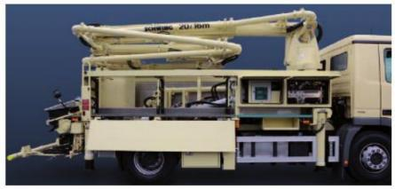
Großzügige Zuladungsmöglichkeiten zeichnen diese City-Pumpe aus - optional sogar mit Boxen für 60 m Schläuche DN 75 von 3 m Länge.
